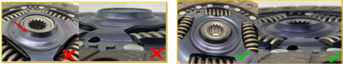
Izquierda: deformación cónica y fracturas por forzar el montaje. Derecha: disco nuevo en buen estado.
