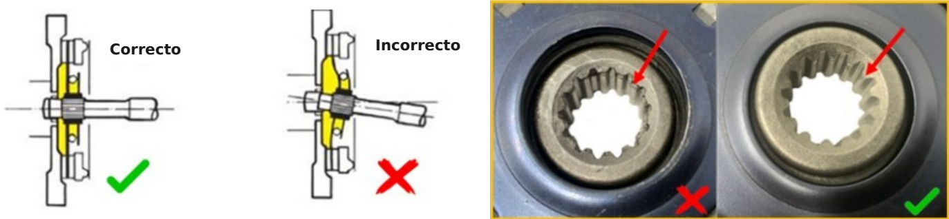
Alineación correcta e incorrecta; estrías dañadas (X) frente a estrías en buen estado (✓).
